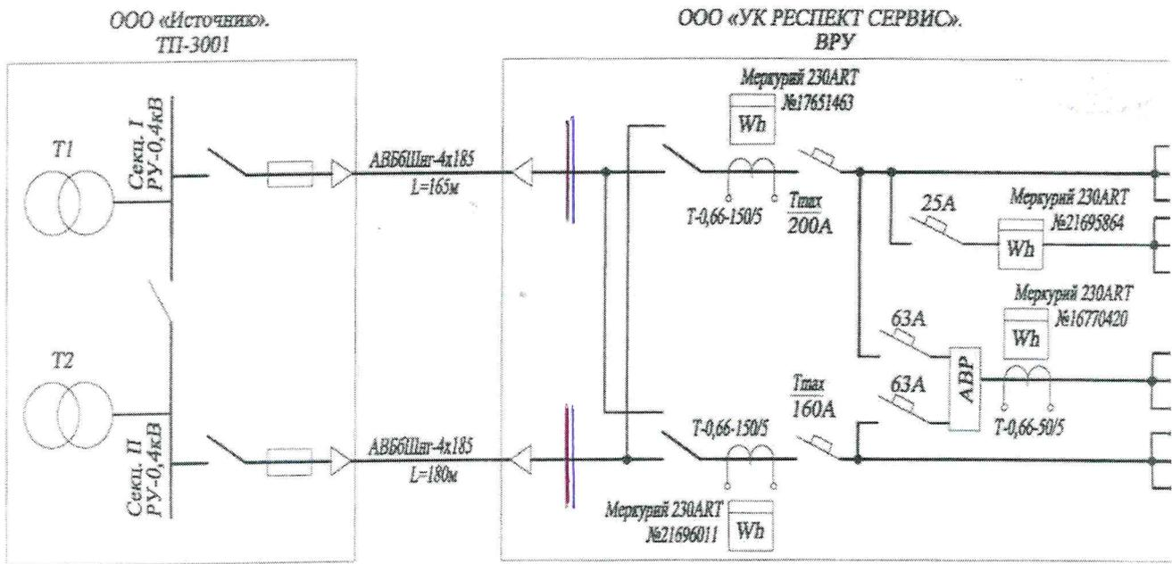
**Примечание:** в схеме указываются места установки и номера приборов учета, параметры измерительных трансформаторов тока и напряжения, границы балансовой принадлежности (красный цвет) и эксплуатационной ответственности (синий цвет), границы с субабонентами (зеленый цвет), длина и марка питающих кабелей (проводов).
