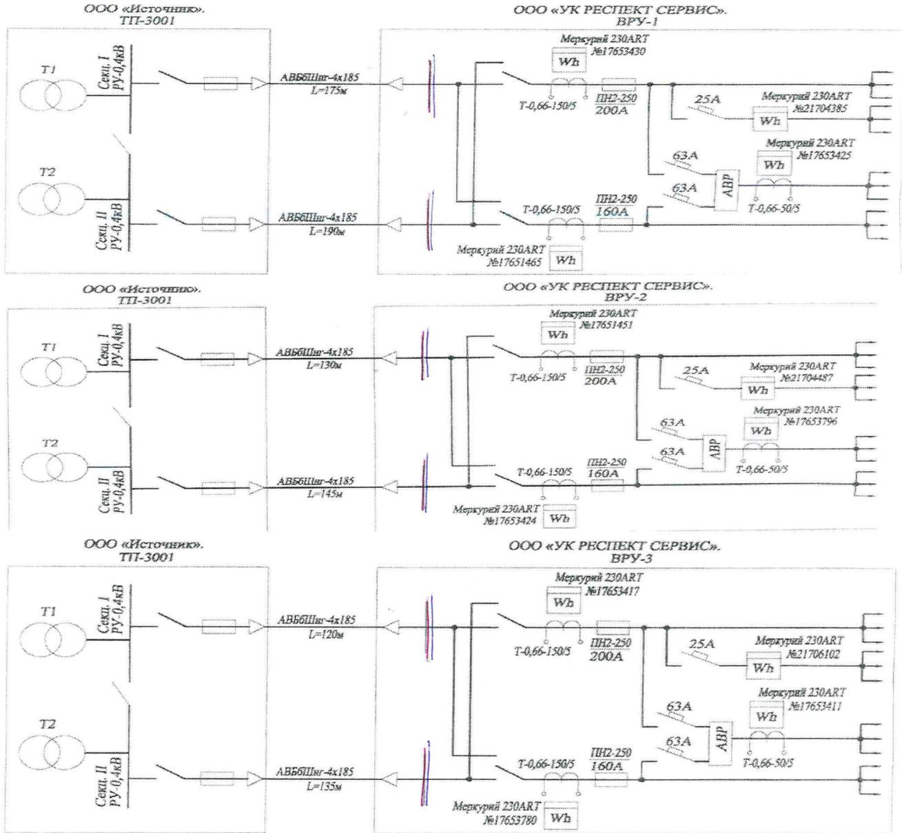
**Примечание:** в схеме указываются места установки и номера приборов учета, параметры измерительных трансформаторов тока и напряжения, границы балансовой принадлежности (красный цвет) и эксплуатационной ответственности (синий цвет), границы с субабонентами (зеленый цвет), длина и марка питающих кабелей (проводов).
