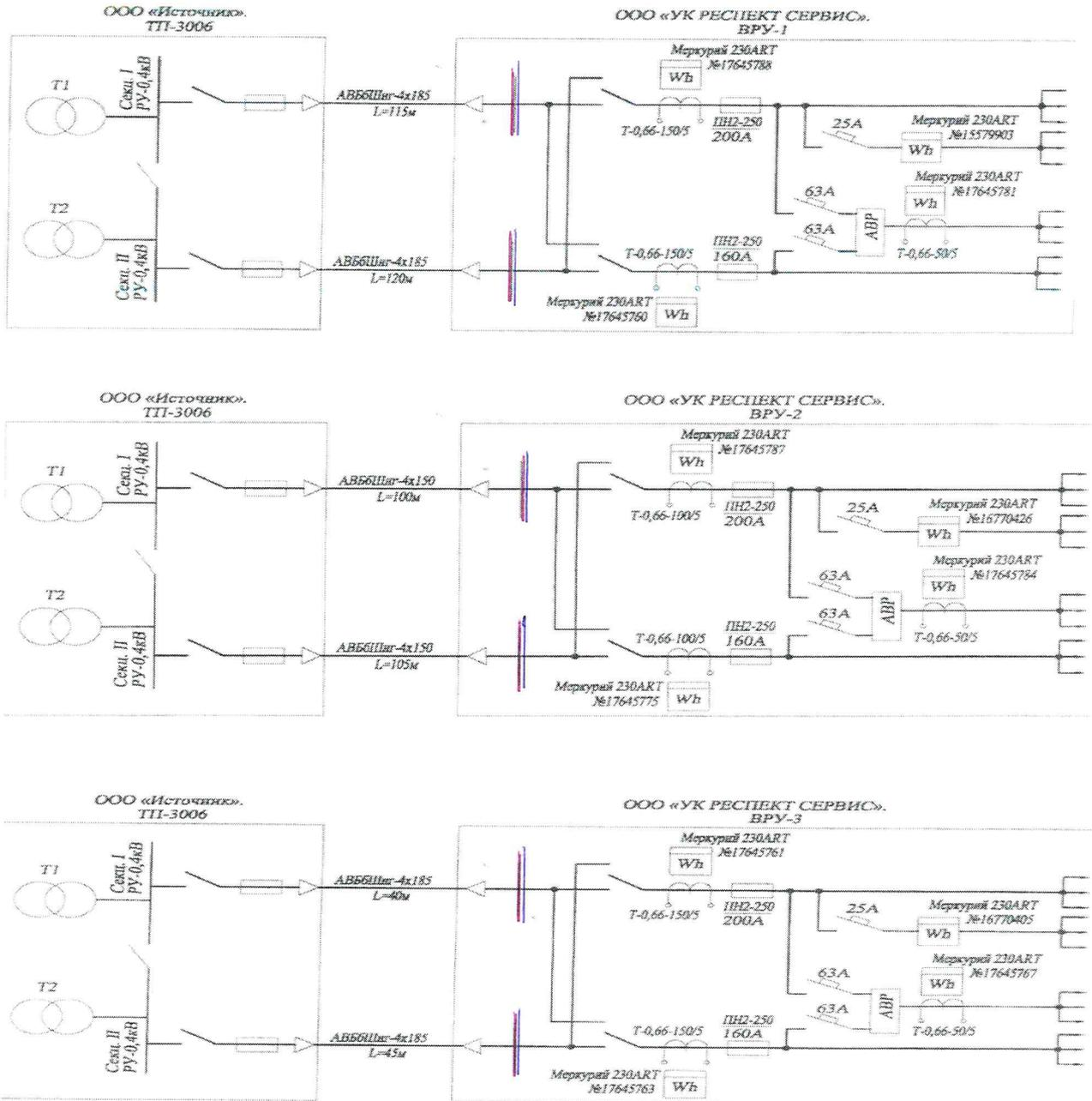
**Примечание:** в схеме указываются места установки и номера приборов учета, параметры измерительных трансформаторов тока и напряжения, границы балансовой принадлежности (красный цвет) и эксплуатационной ответственности (синий цвет), границы с субабонентами (зеленый цвет), длина и марка питающих кабелей (проводов).
